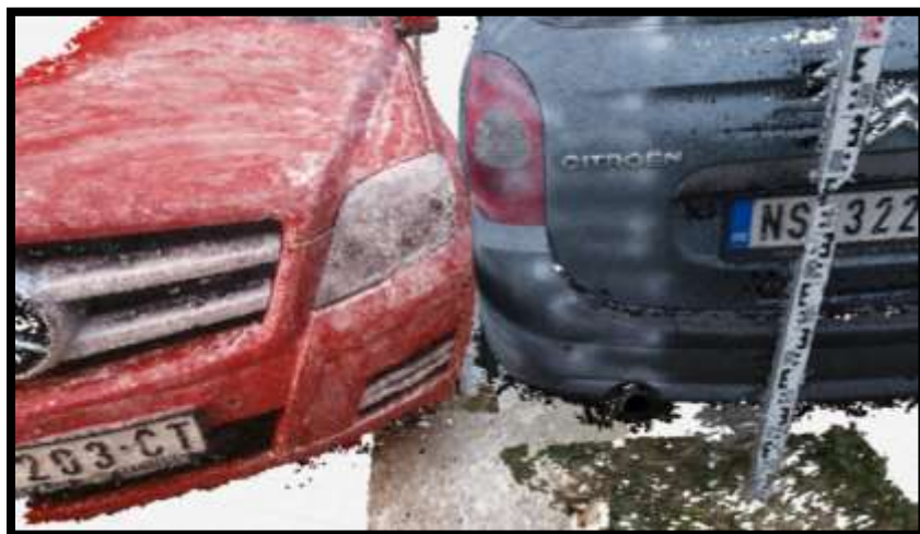
6. ábra – Point Cloud formátumú részletszint Virtual Crash 4-ben
